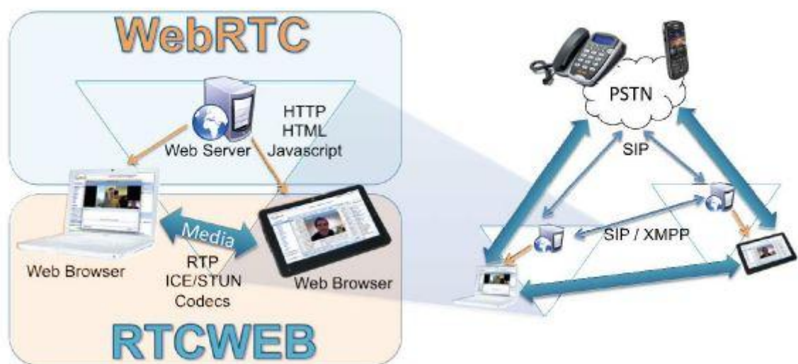
Figura 6 - Schema di riferimento delle iniziative WebRTC(W3C)e RTCWeb(IETF)
