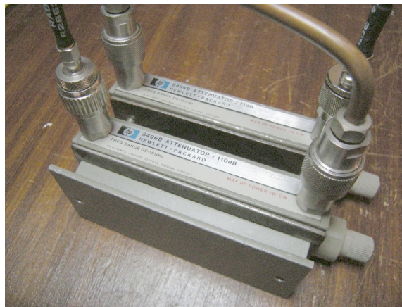
Fig. 3.3.3: Attenuatore Hewlett-Packard (0-110 dB, DC-18 GHz, 1W CW)
