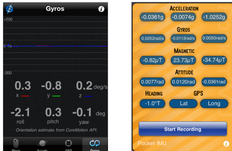
Figura 3.12: xSensor Pro: misurazioni giroscopio e stima orientamento. Pocket IMU: misurazioni sensoriali e orientamento
