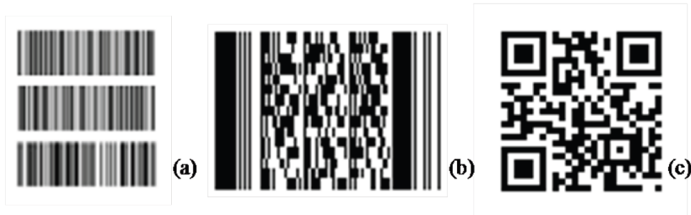
Figura 4.2: Evoluzione dei codici bidimensionali: codici a barre multipli, codici stackable e codici a matrice
