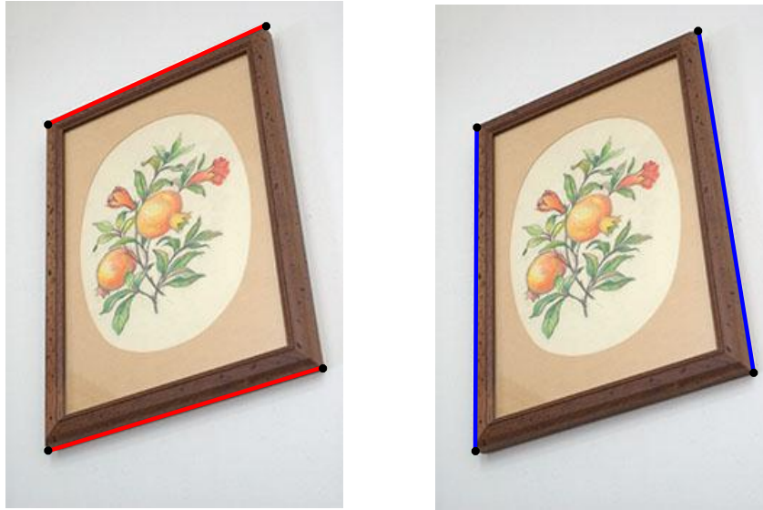
Figura 4.14: Punti di riferimento e relative rette da inserire per attuare la correzione prospettica mediante programma
