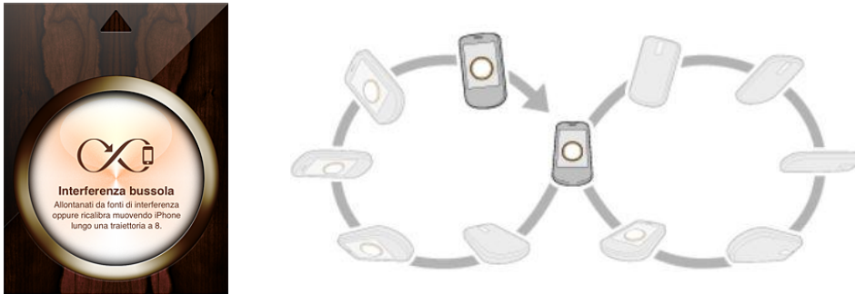
Figura 3.9: Schermata di calibrazione della bussola nei dispositivi Apple e movimento "a 8"
