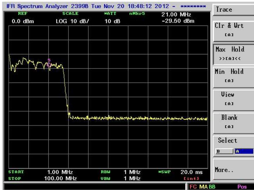
Fig. 4.6: Spettro Powerline su impianto TV
