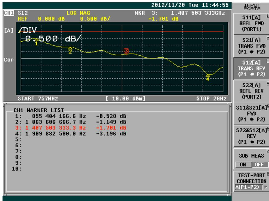
Fig. 3.5: Caratterizzazione derivatore 1 uscita derivata da -10 dB adattato
