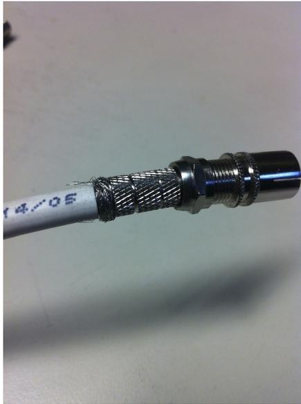
**Fig. 3.12: Connettore installato in modo scorretto**
